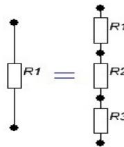
Получен правильный ответ и показана схема соединения резисторов
